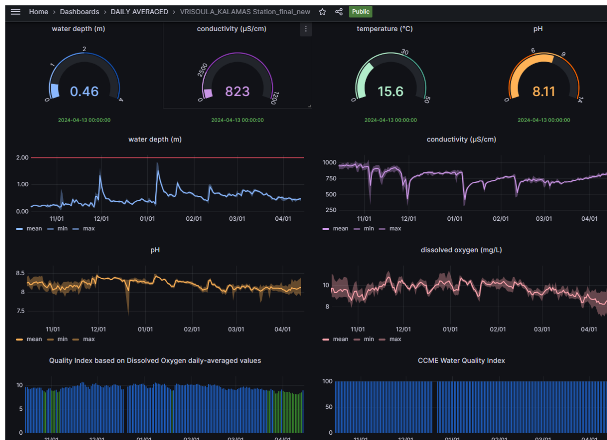
Εικόνα 2: Πίνακας Ελέγχου (dashboard) σταθμού ‘Βρυσούλα’ με τα δεδομένα του τελευταίου εξαμήνου
